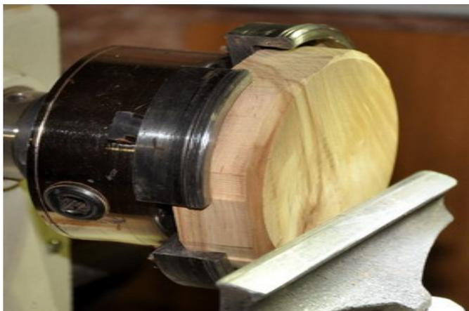
Poi si fa uno scavo cilindrico profondo 5 mm da 50 di diametro.
